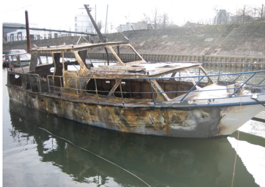
Ausgebrannte Motoryacht nach Verpuffung
